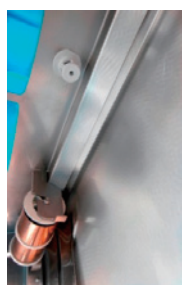
ドア背面にノズルを設置 (前洗淨部)
